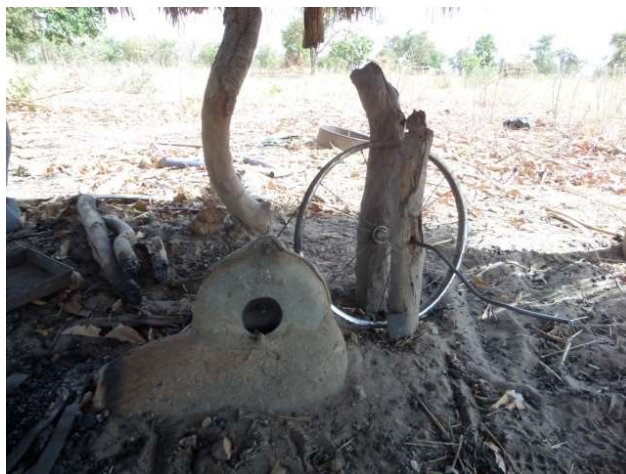
Photo n°6 : Compresseurs à air en cerceau, dynamique technologique
